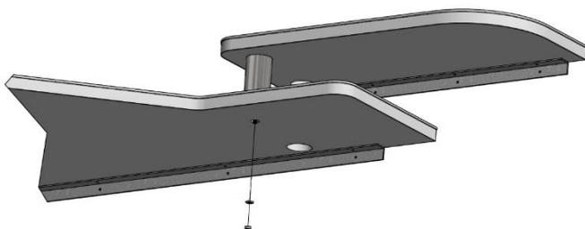
9/ Fixez la tablette au mur dans les trous réalisés à l'étape (6).
