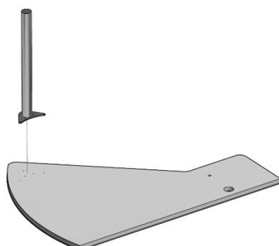
3/ Fixez le grand pied support (3) sur la platine de fixation puis fixer le pied avec la platine sur le plan de travail (1) avec les vis M4x4 fournies au niveau des pré-trous présents sur le plan de travail (1).
